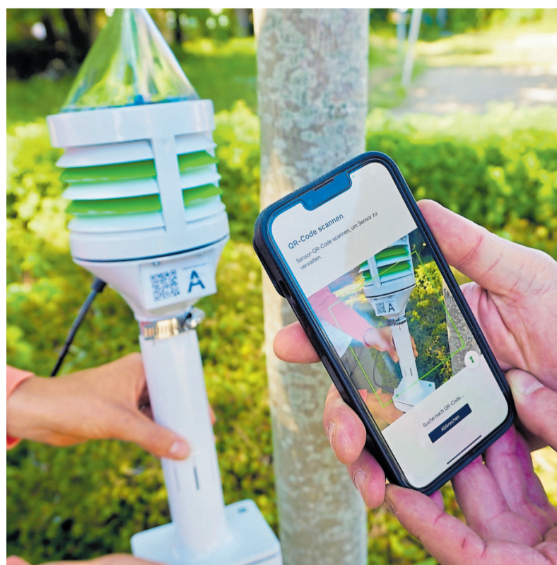
Egal ob neben dem Baum im Boden angebracht, wie hier gezeigt, oder auch mit einem kleineren Gerät direkt am Baum befestigt – jeder Sensor hat einen eigenen QR-Code. Die Werte sind auf dem Handy abzulesen. Foto: Carolin Hlawatsch
